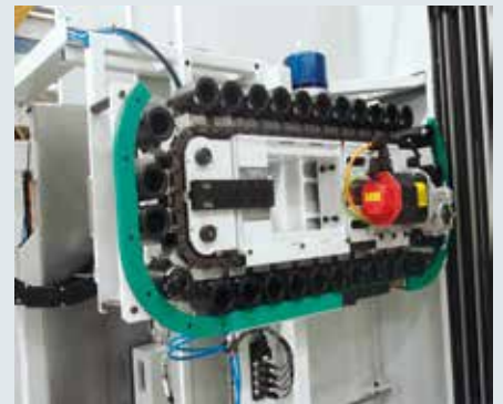
■ Magazzino utensili collegato al montante, riduce i tempi di cambio utensile. Tool magazin connected to the column to reduce the tools changing time.
